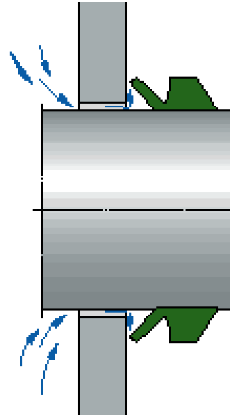
obr. 13.: Těsnící funkce – ventil plastického maziva [3]
