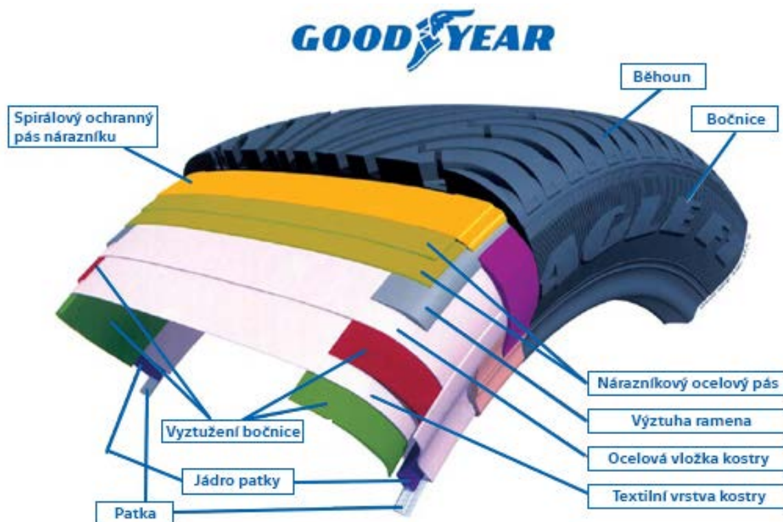
Obr. 1 Konstrukce pneumatiky GOOD YEAR
