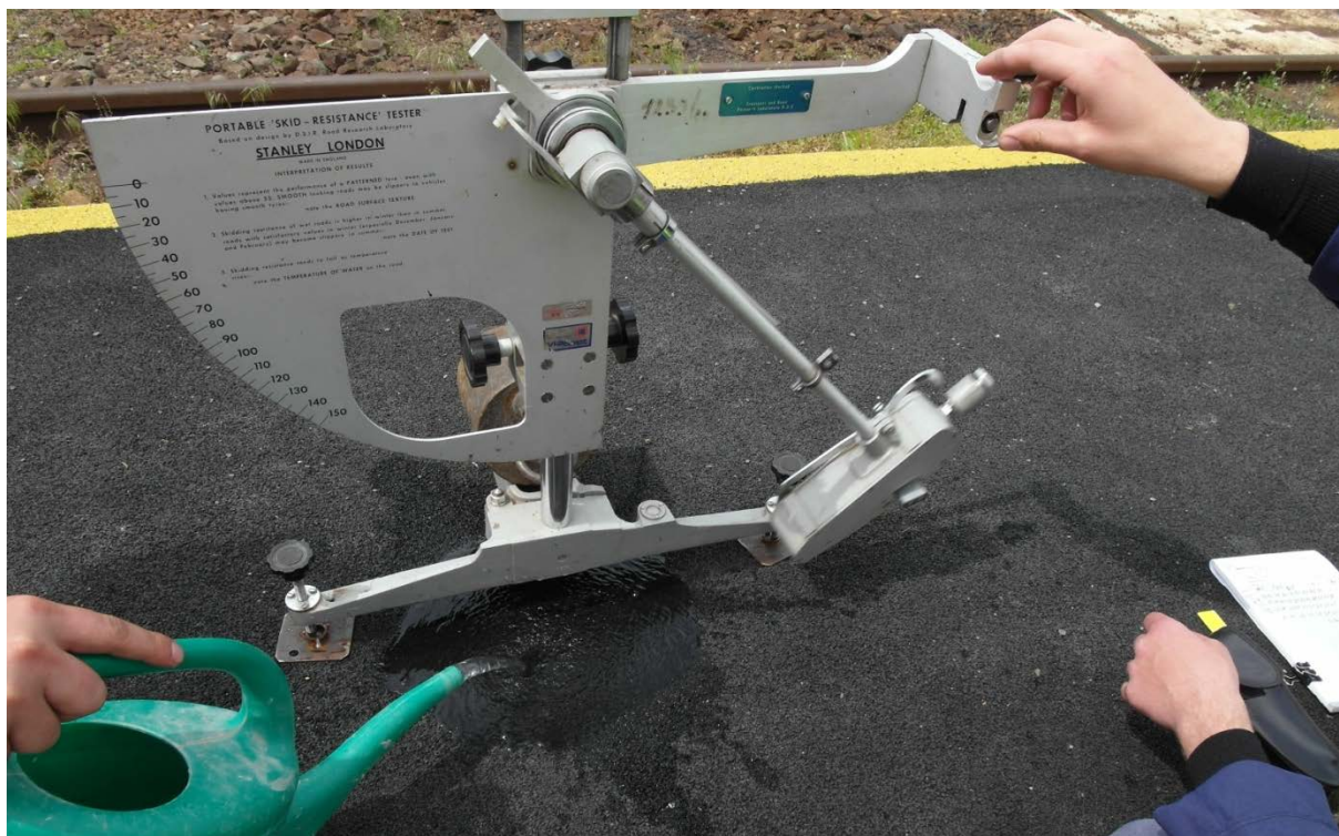
Obr. 81 Měření povrchu nástupiště pod proudem vody
