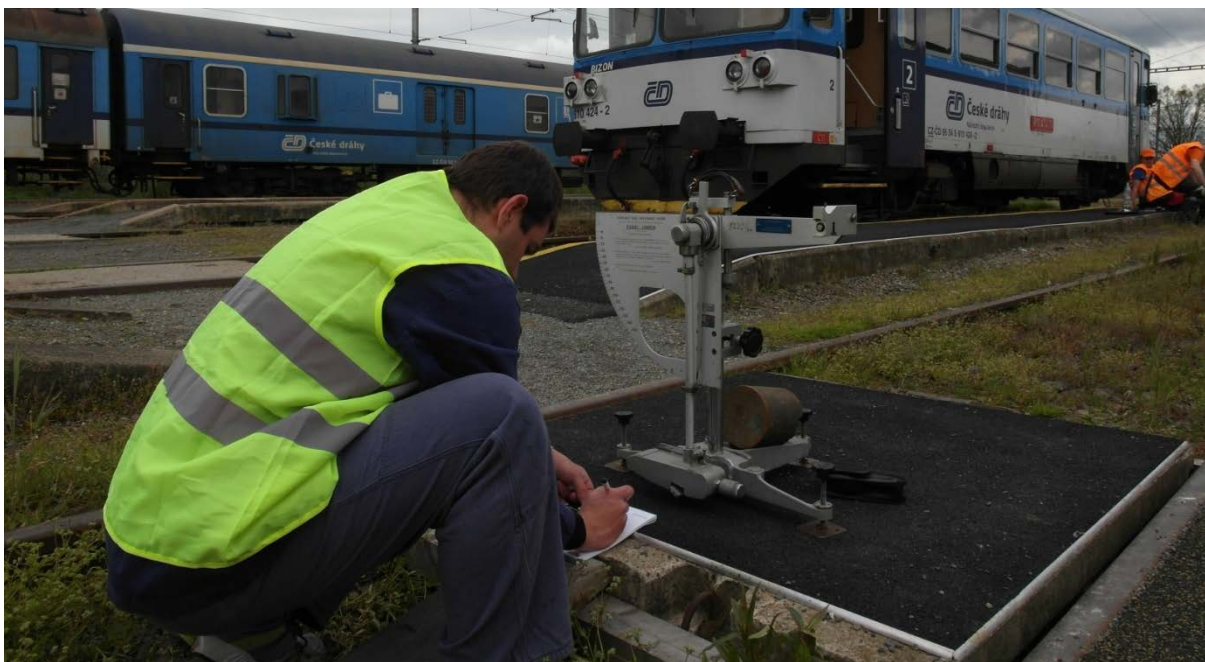
Obr. 78 Kontrola "nulového čtení"
