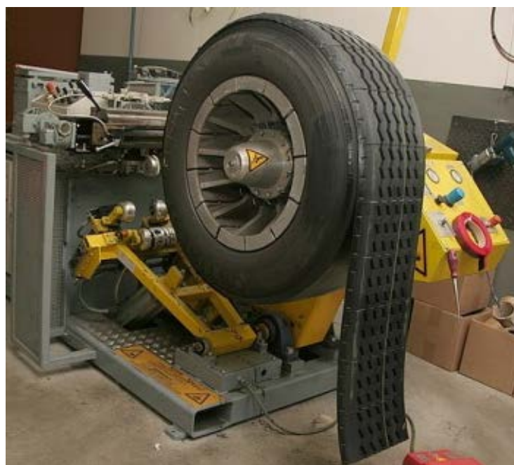
Obr. 4 Navalování běhounu nákladního protektoru
