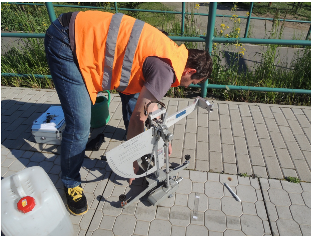
Obr. 111 Příprava přístroje před měřením - vyrovnání přístroje
