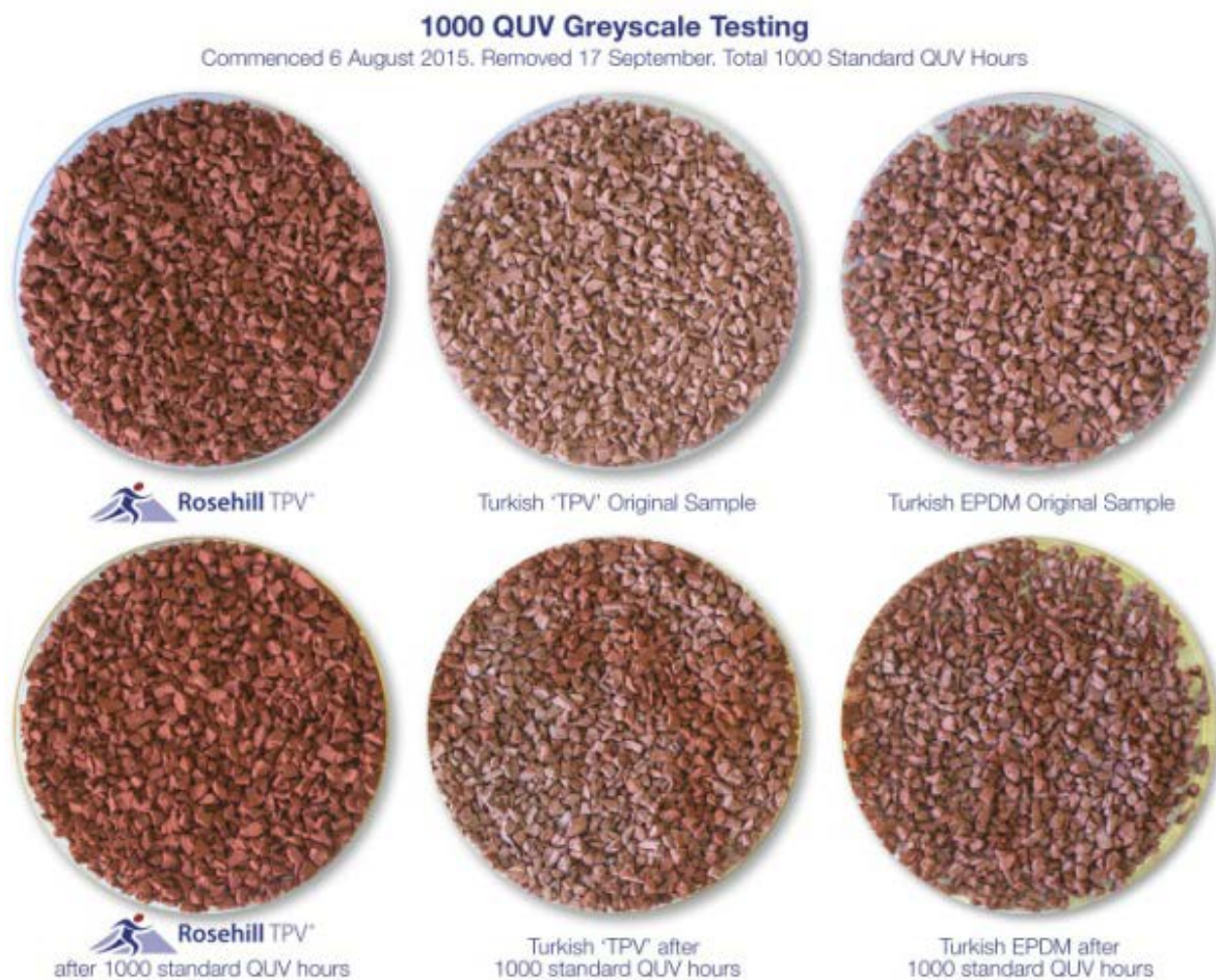
Obr. 48 Ukázka UV stability Rosehill TPV granulátu a tureckého TPV a EPDM granulátu
