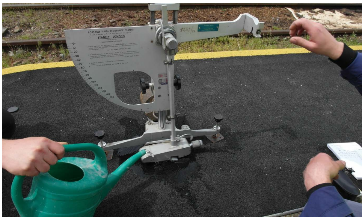
Obr. 82 Měření povrchu nástupiště pod proudem vody
