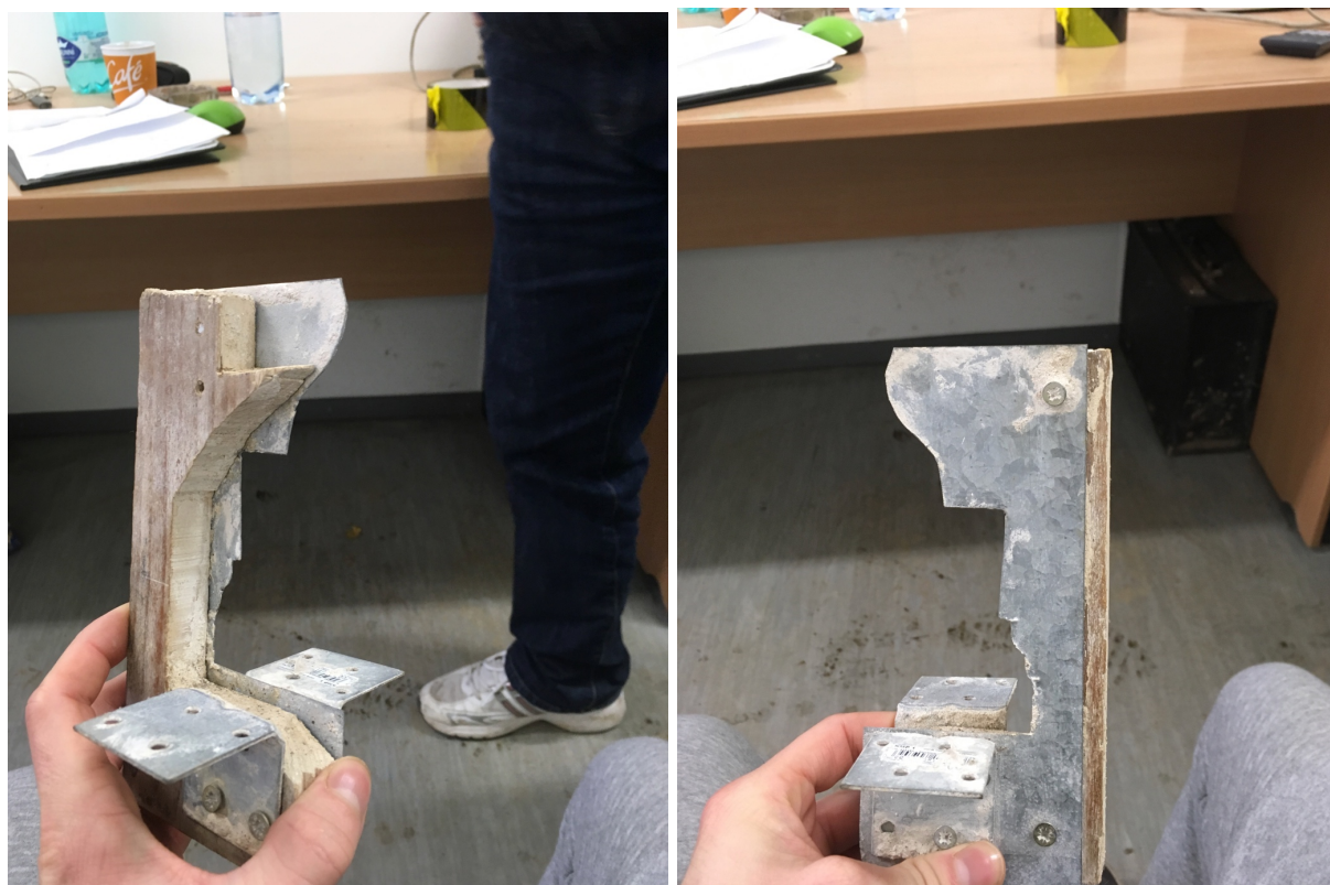
Obrázek 10: Jezdec pro štukování kamenného parapetu – pohled 1
