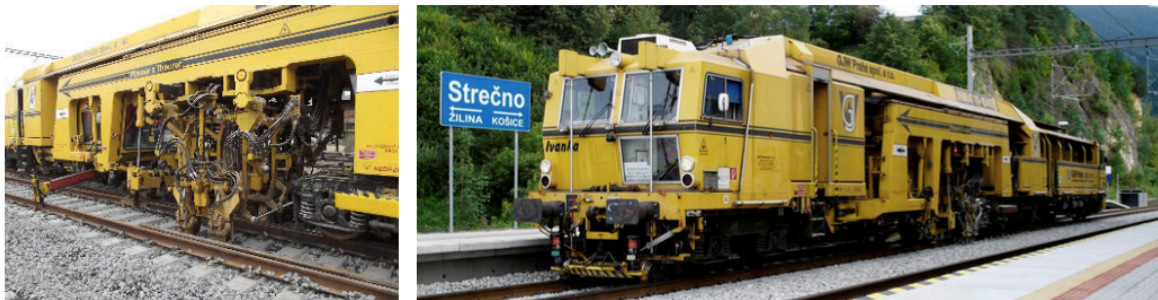
Obrázek 18: Automatická strojní podbíječka Unimat 09-16/4S
