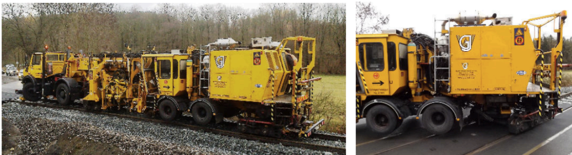
Obrázek 17: Dvoucestná strojní podbíječka UST 78 U
