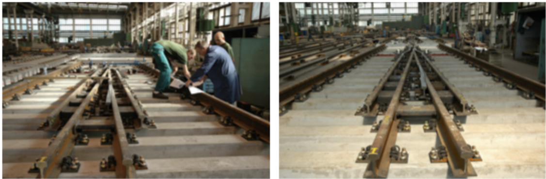
Obrázek 32: Realizovaná dodávka železniční výhybky - Stříbro
