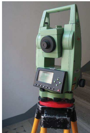
Obr. 3.1: Totální stanice Leica TCR 307
