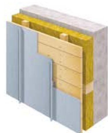
DETAIL UPEVNĚNÍ VLNITÉHO PROFILU NA NOSNÉM ROŠTU
