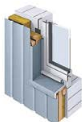
DETAIL UKONČENÍ VLNITÉHO PROFILU KOLEM OTVORŮ
