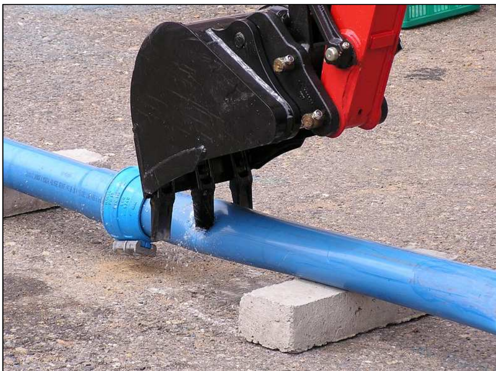
Obr. 11. Potrubí z molekulárně orientovaného PVC (MO-PVC) (6)
