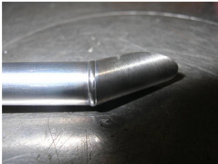
Obr. 4 Součást svařená za pomoci laseru (11)
