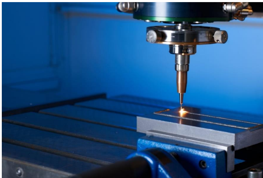
Obr. 9 Laserová hlava s koaxiálním podáváním drátu (29)
