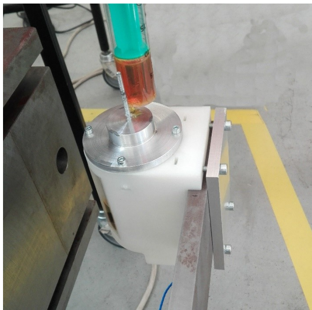
Obrázek 9-10 - Měření hltiče s tlumením – napouštění olejové náplně
