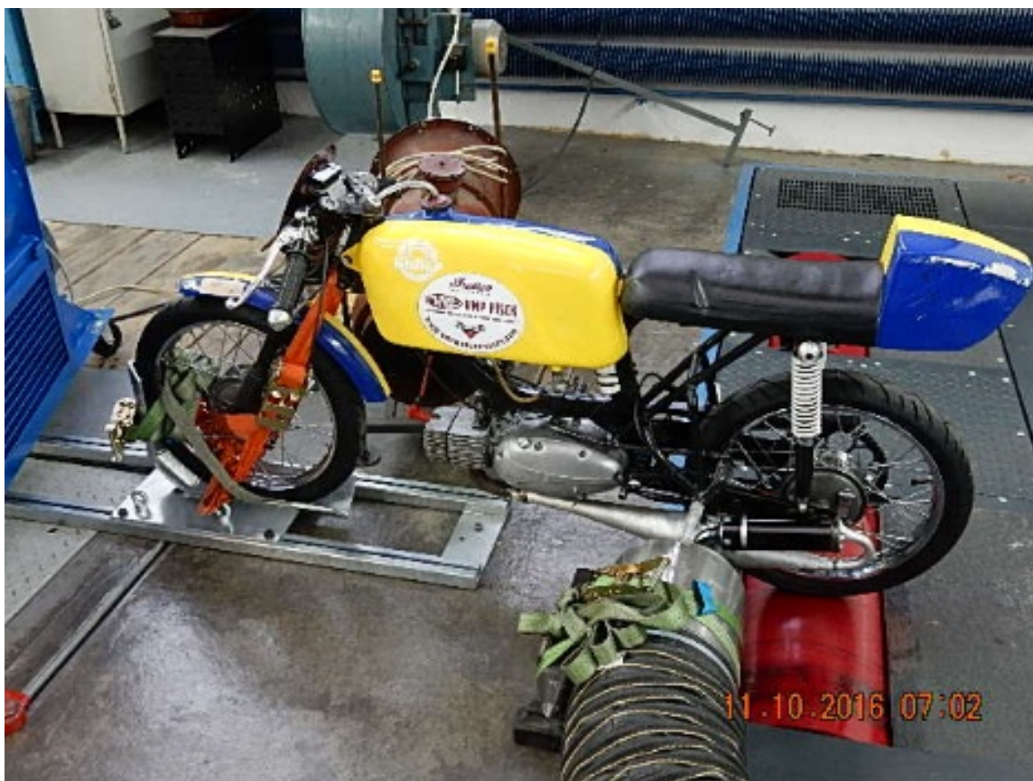
Obr. 28: Motocykl upevněný na válcovém dynamometru
