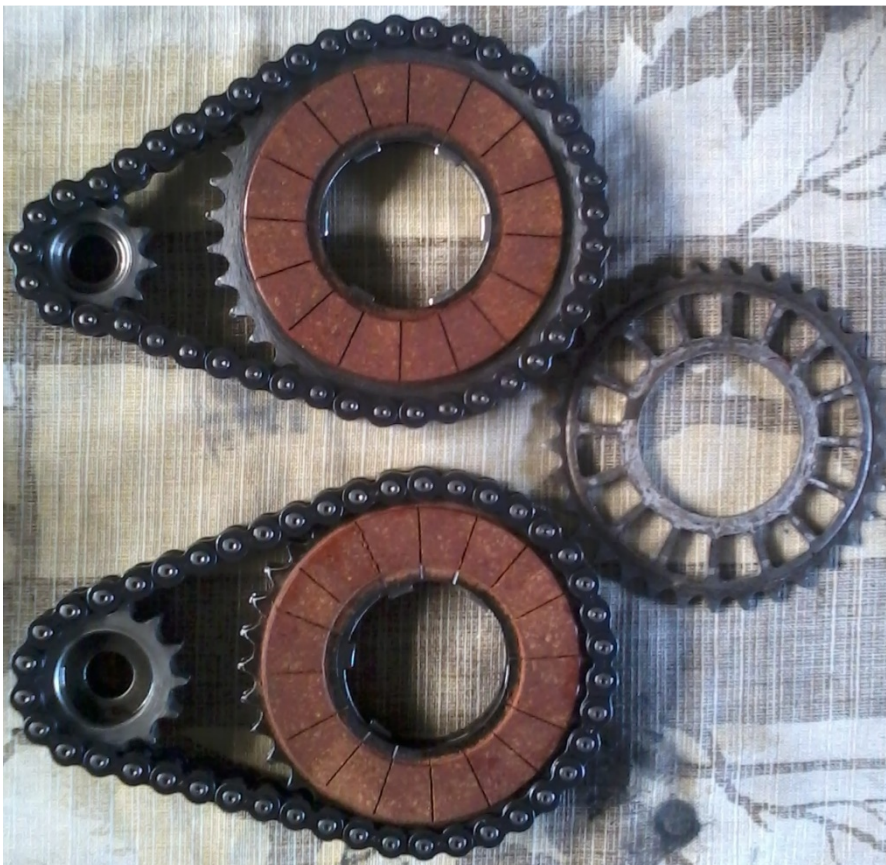
Obr. 25: Upravená rozjezdová spojka a primární převod
