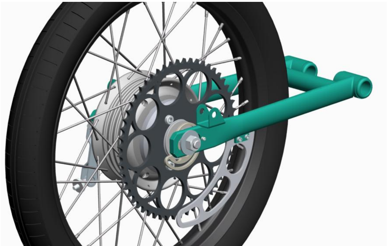
Obr. 33: Pohled na přepracování uložení rozety tak jak jej provedl Vít Poucha
