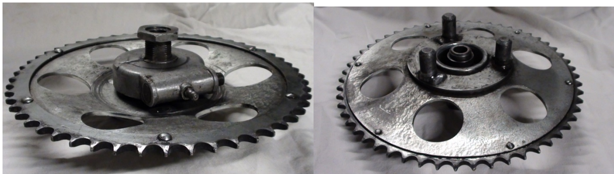
Obr. 24: Originální provedení rozety s unašečem a náhonem rychloměru
