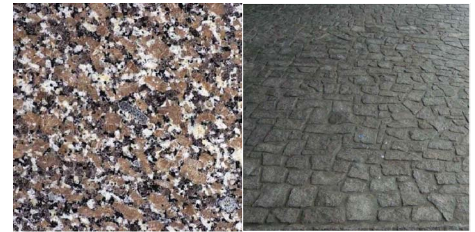
LIBERECKÁ ŽULA - MÍSTNÍ MATERIÁL SUTERÉNNÍ A OPĚRNÉ STĚNY, ZPEVNĚNÉ PLOCHY
