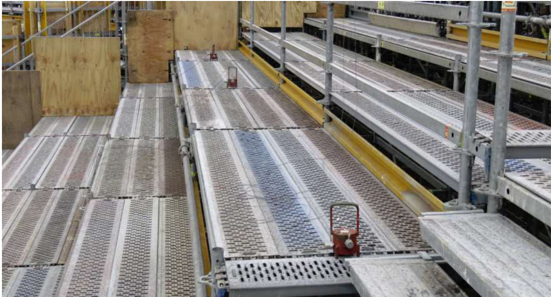
Obrázek 20 – 1. pozice (cesta nahoru) závaží se snímači v jedné měřené řadě ve směru X
