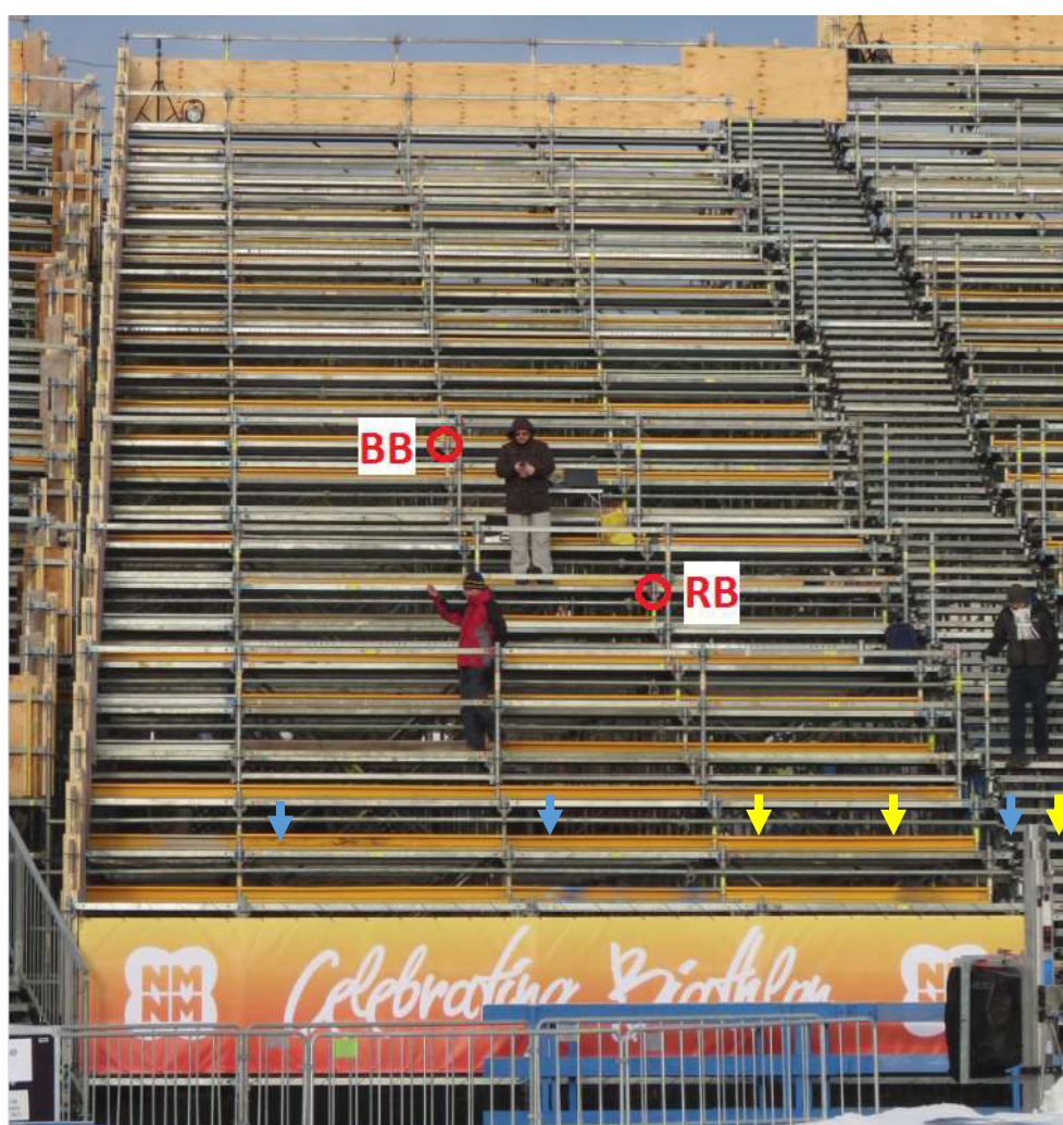
Obrázek 17 - Pozice budícího bodu (BB) a referenčního bodu (RB), modré šipky značí cestu nahoru, žluté šipky značí cestu dolů
