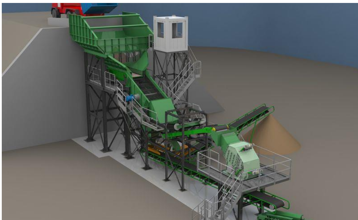
Obr. 3 – Stacionární recyklační linka [6]
