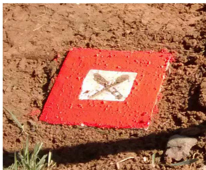
Obr. 2 Kamenná měřická značka M2 s vysekaným křížkem [4]
