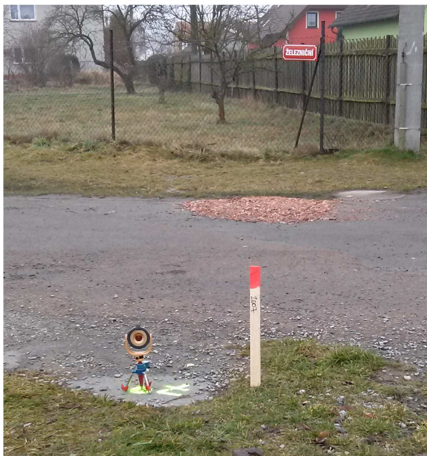
Obr. 4 Měření bodů (signalizace pomocí tzv. chobotnice) [7]
