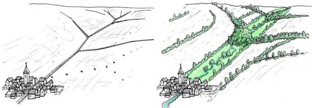
Obrázek 2.2: Ilustrace technického protierozního opatření, AOPAK ČR[28]
