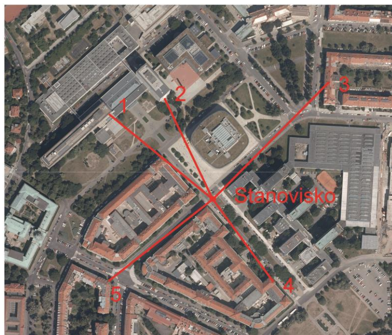
Obr. 4 - Poloha stanoviška a rozložení bodů pro horizontální test [5]
