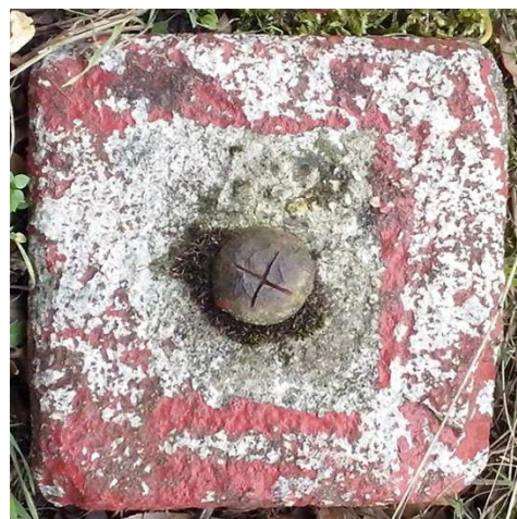
Obr. 4.3.4: Kamenná povrchová značka M2 se zabetonovaným nivelačním znakem s vyřezaným křížkem
