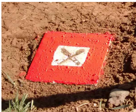
Obr. 4.3.3 Povrchová kamenná měřická značka M2 s vysekaným křížkem
