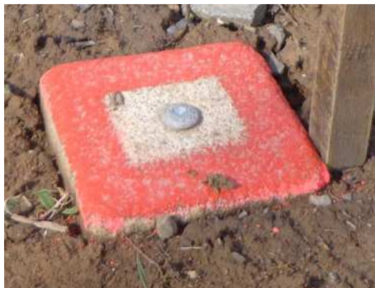
Obr. 4.3.5 Povrchová kamenná měřická značka M2 se zavrtaným hřebem
