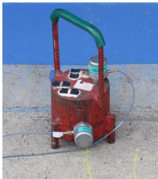
Obr. 17 Upevnění snímačů na ocelové závaží
