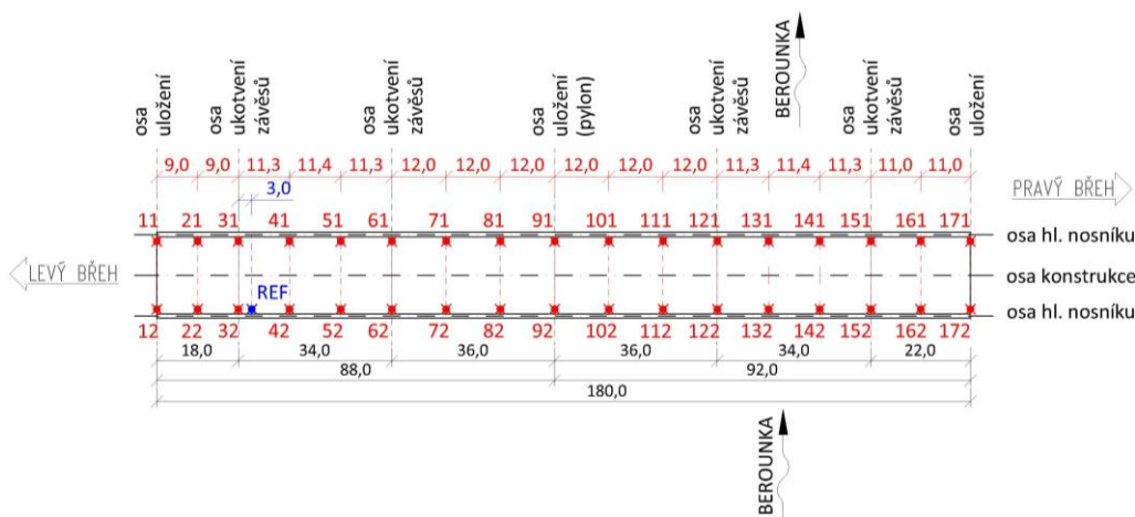
Obr. 19 Zjednodušená situace s vyznačením sítě měřených bodů
