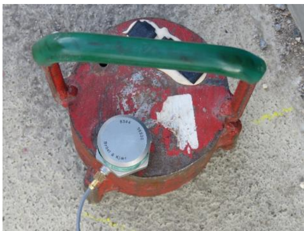
Obr. 16 Upevnění snímače na ocelové závaží
