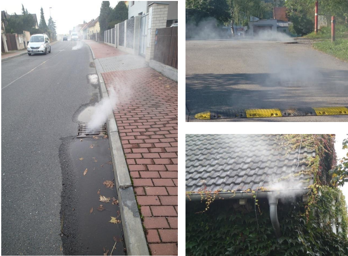
Obrázek 4 Průběh kouřové metody, špatně napojený dům, PVK
