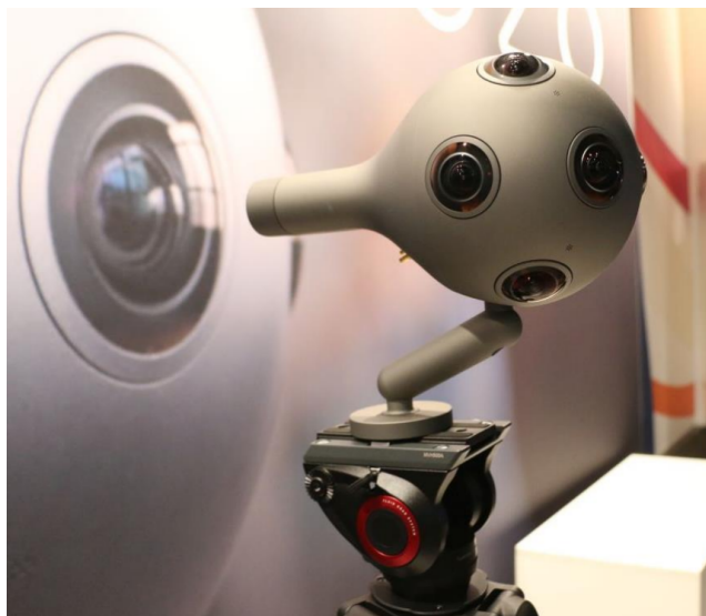
Obrázek 1.1: Kamera Nokia OZO schopná natáčet v rozlišení 8K, převzato z [1]
