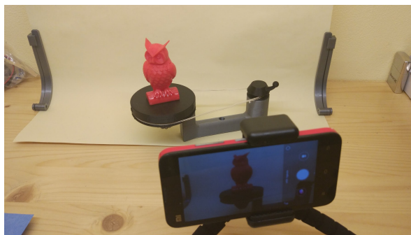
Obrázek 6.5: Testovací prostředí s otočným podstavcem
