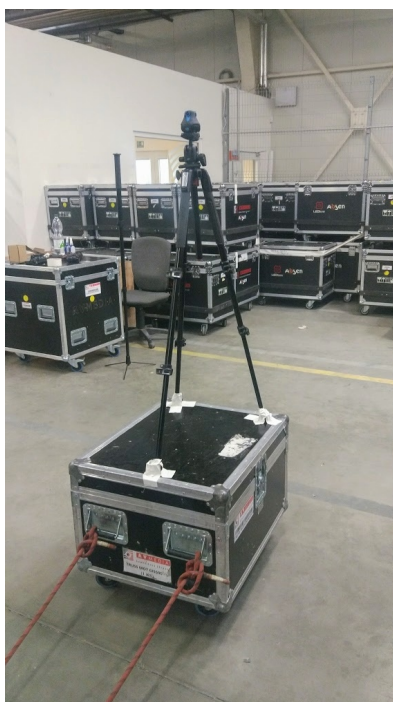
Obrázek 7.7: Pojízdný sférický camera rig
