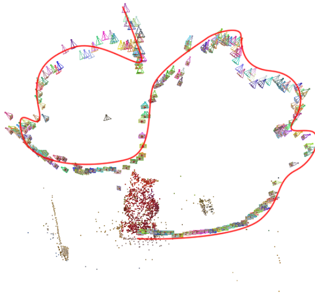
Obrázek 6.6: Rekonstrukce trajektorie kamery a geometrie snímaného objektu
