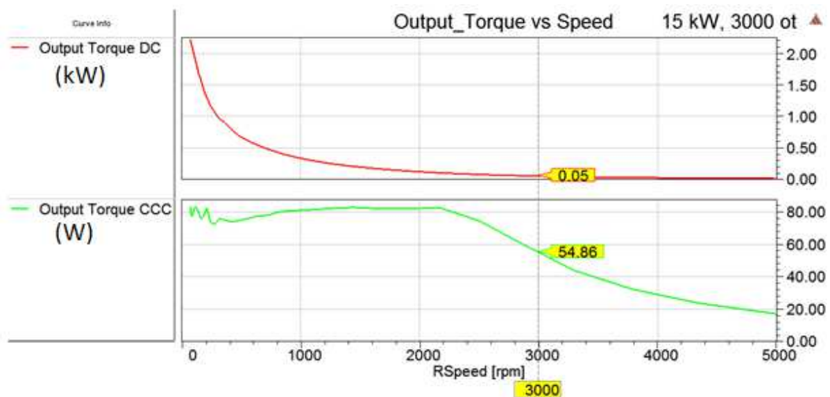
Obr. 5. 2 Graf závislosti výstupního momentu a rychlosti pro DC a CCC řízení
