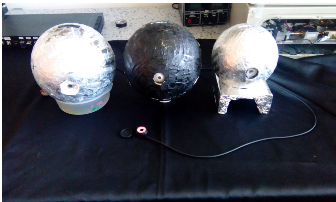
Obr. 8. Navržené integrační koule s detektorem Thorlabs S122C
