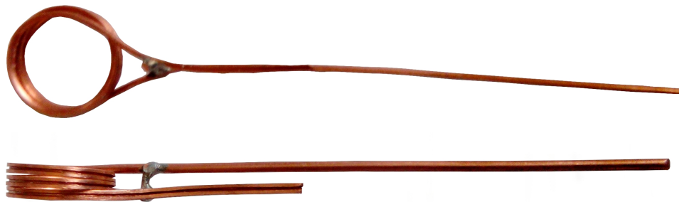
Obr. 25. V-drážka pro uchycení optického vlákna o definovaném poloměru R = 7,7 mm; navinout lze maximálně 3 závity, tzn. že navinutá délka vlákna l_{max} = 133 mm
