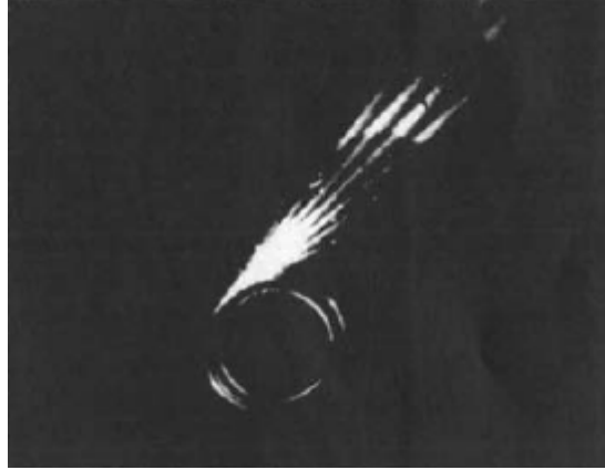
Obr. 8. Reálná ukázka vyzařování (převzato z [6]); vlákno stočeno v rovině kolmé na směr pozorování, jsou zde zřetelně patrné vystupující svazky
