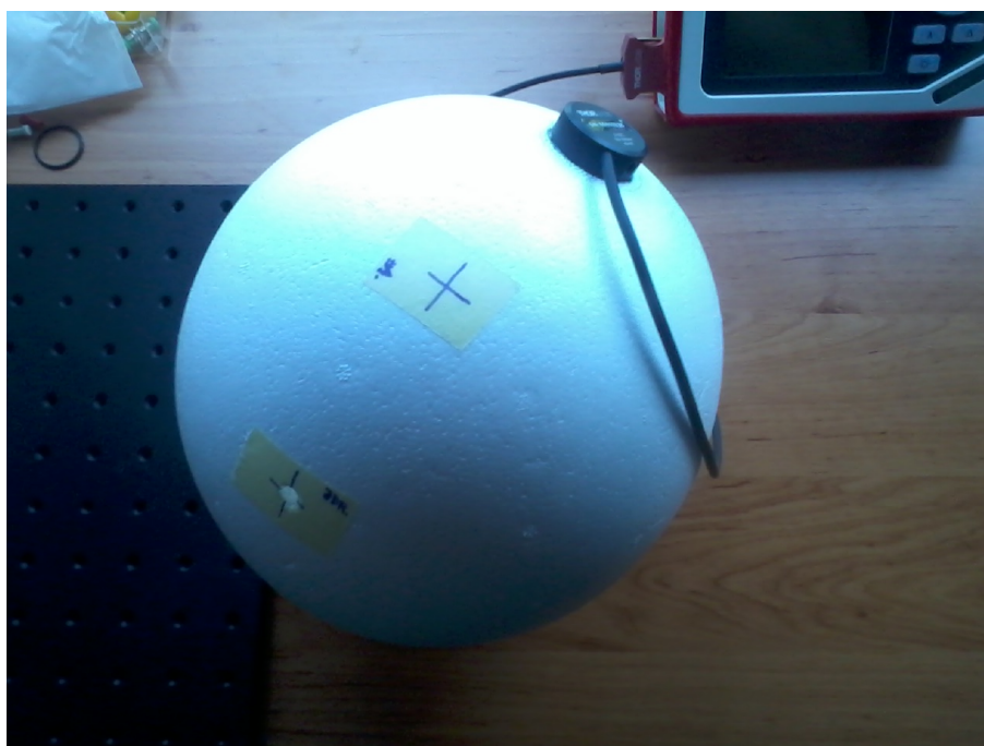
Obr. 3. První orientační měření vlastností polystyrénových integračních koulí
