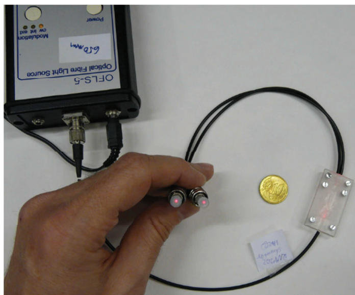
Obr. 8.9: 1x2Y rozbočnica so substrátom VEROCLEAR a vlnovodnou vrstvou NOA72 – vzorka KNVB02.
