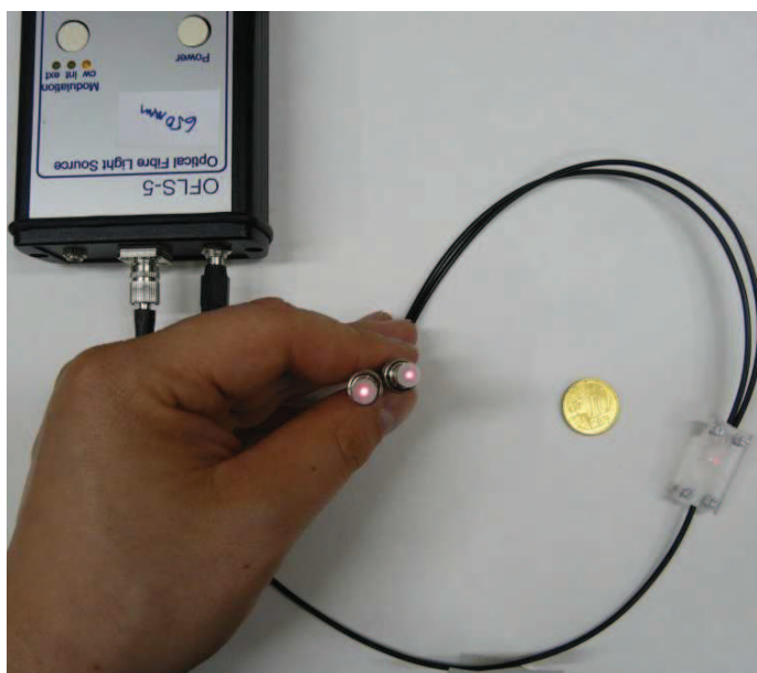
Obr. 8.8: 1x2Y rozbočnica so substrátom PMMA a vlnovodnou vrstvou NOA72 – vzorka KN103.
