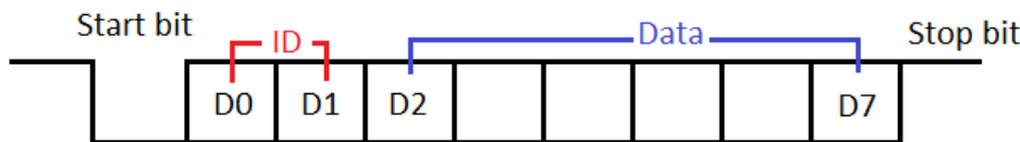
Obrázok 4.2: Koncept prenosu dát po rozhraní UART (Pozn. použité MCU štandardne nepodporuje paritu)
