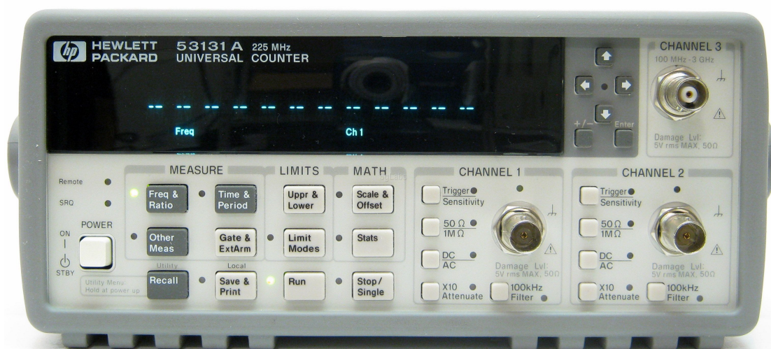
Obrázek 3.1: Univerzální čítač HP 53131A. Tento model disponuje dvěma kanály o šířce pásma 225 MHz s možností třetího kanálu s pásmem 1,2 GHz. Základními funkcemi čítače jsou: měření frekvence, měření periody, měření střídy, měření poměru frekvencí. Přístroj umožňuje nastavit rozhodovací úroveň, terminaci ( 50\ \Omega , 1\ M\Omega ), vazbu (AC, DC) a další parametry zpracování signálu. Zdroj: [2]
