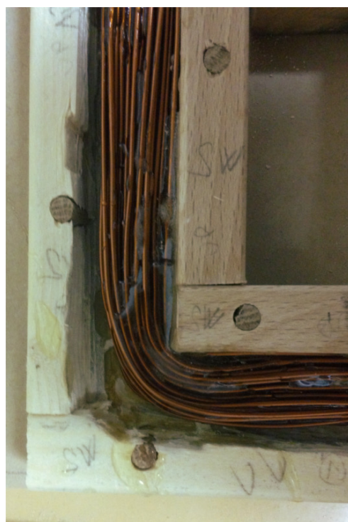
Obrázek 13: Detail budicí cívky před zalitím do epoxidu.
