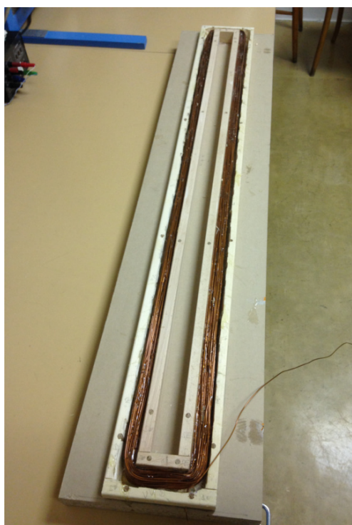
Obrázek 12: Hotová budicí cívka před zalitím do epoxidu.
