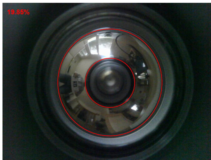
Obrázek 4.2: Zachycený obraz s panoramatickým nastavcem, rozlišení kamery 640x480 pixelů.
