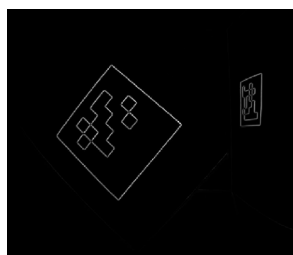
Obrázek 2.19: Proces rozpoznání - lokální gradient velikosti (z [21]).
