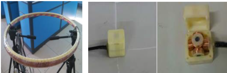
Obrázek 2.5: Vysílací cívka (vlevo) a tříosý detektor (převzato z [12]).
