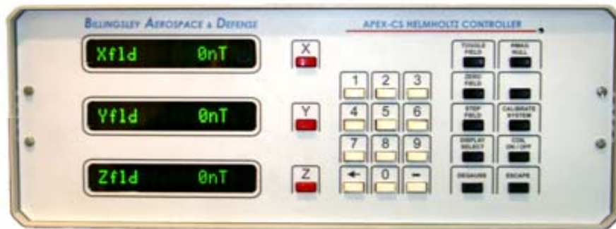
Obrázek 2.5: Budicí jednotka Billingsley APEX-CS [převzato [III]]
