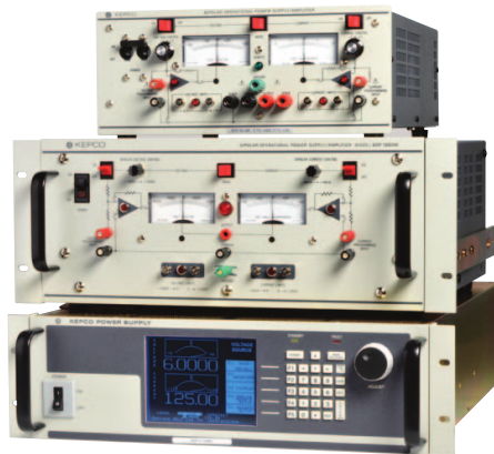
Obrázek 2.3: Bipolární zdroje firmy KEPCO [převzato [1]]
