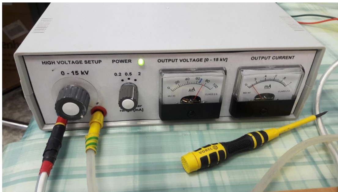
Obrázek 7.4: Okamžité napětí a proud zdroje pro korónový výboj
