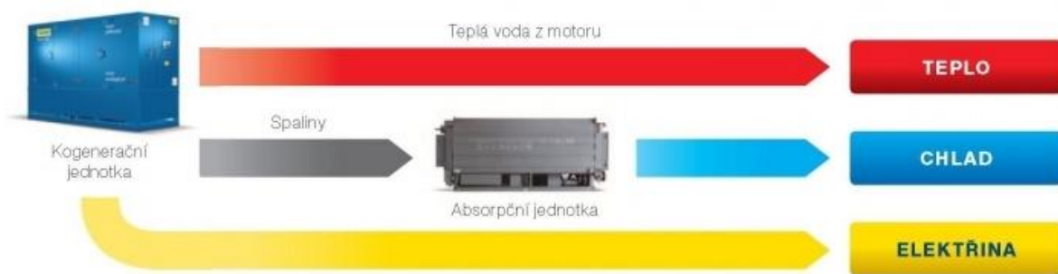
Obrázek 13 Zapojení trigenerace pro souběžnou dodávku tepla a chladu [53]
