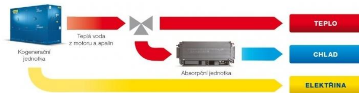
Obrázek 12 Zapojení trigenerace pro dodávku tepla v zimě a chladu v létě [53]
