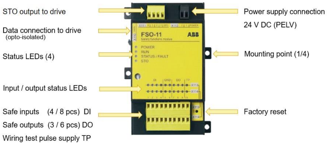
Obrázek 24 Bezpečnostní modul FSO-11 [24]
