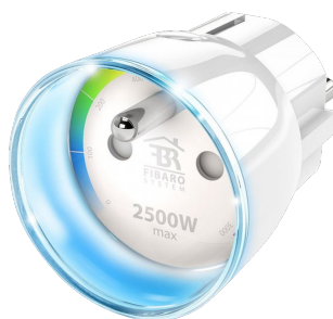
Obrázek 11.3: Inteligentní zásuvka od společnosti Fibaro umožňuje spínat zátěž, monitorovat aktuální příkon i celkovou spotřebu elektrické energie. [42]
