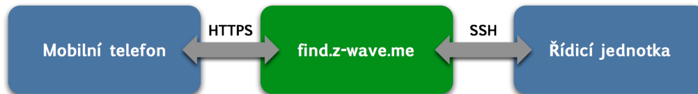
Obrázek 8.2: Princip vzdáleného přístupu přes službu find.z-wave.me
