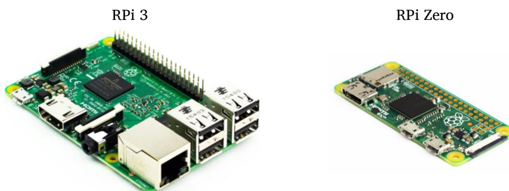
Obr. 22: Vybrané verze Raspberry Pi počítače 13
