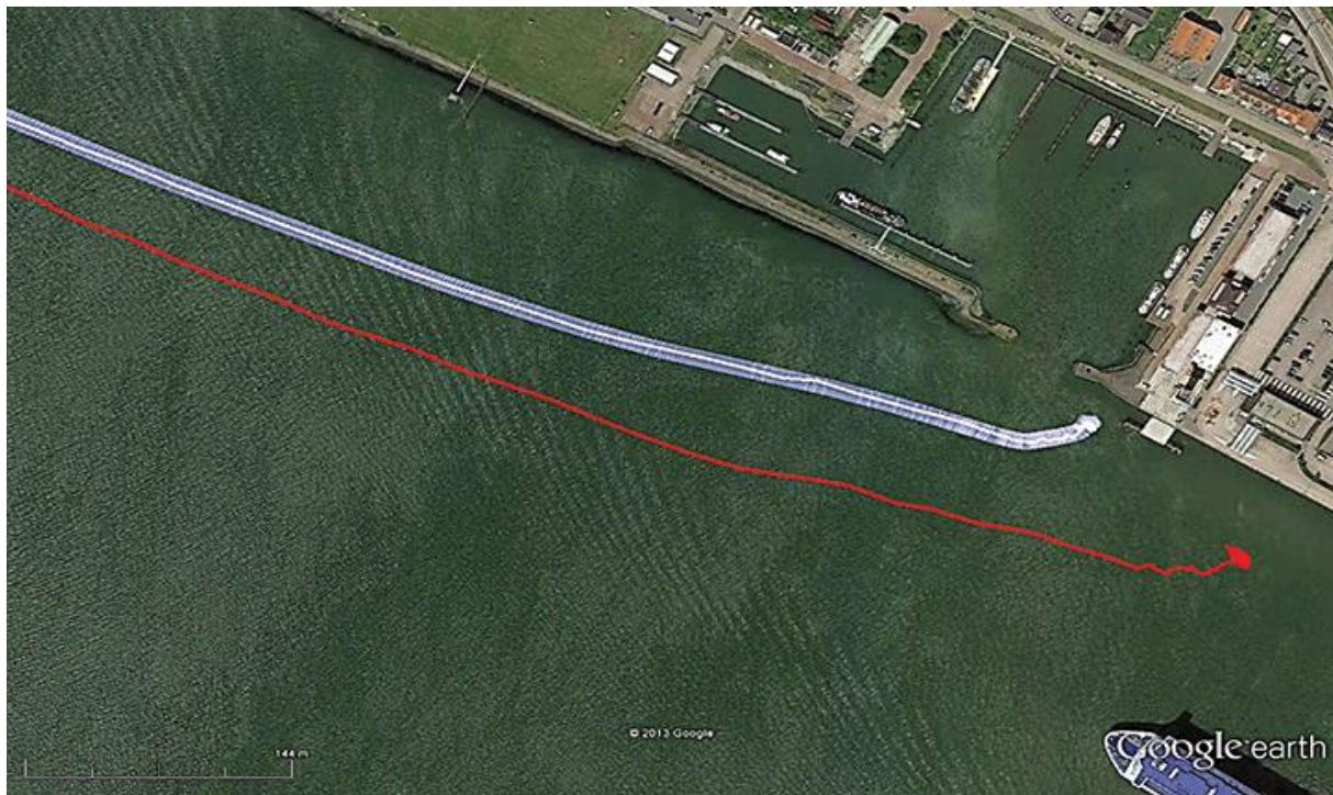
Obrázek 13: Navigace plavidla pomocí eLoranu. Červená křivka je poloha určená základním eLoranem (bez korekcí), modrá je GPS s korekcemi, a bílá je výstup eLoranu (zároveň vyznačuje skutečnou trasu, převzato z [19])
