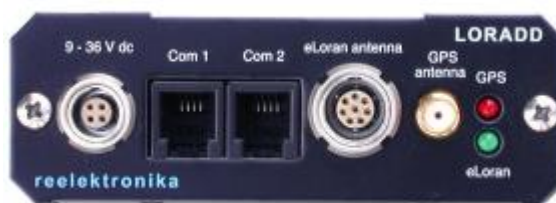
Obrázek 40: Strana přijímače Reelektronika LORADD s konektory pro napájení, antény GPS a Loranu, a ethernetovým rozhraním pro spojení s počítačem, převzato z [51]
