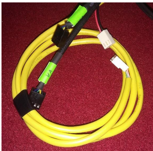
Obrázek 25: Vývody pro TEMP 1 (žlutý), FAN1, FAN2 (černý), FAN3 (černo-červený)
