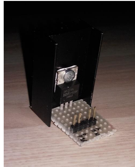
Obrázek 18: Realizované spínání článků. (Na obrázku MOSFET s chladičem)
