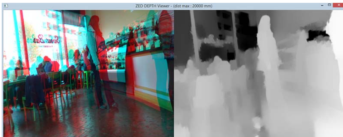
OBRÁZEK 6 – ZPRACOVÁNÍ VÝSTUPU SNÍMKŮ STEREOKAMERY - 3D ANAGLYF A DEPTH MAP [10]
