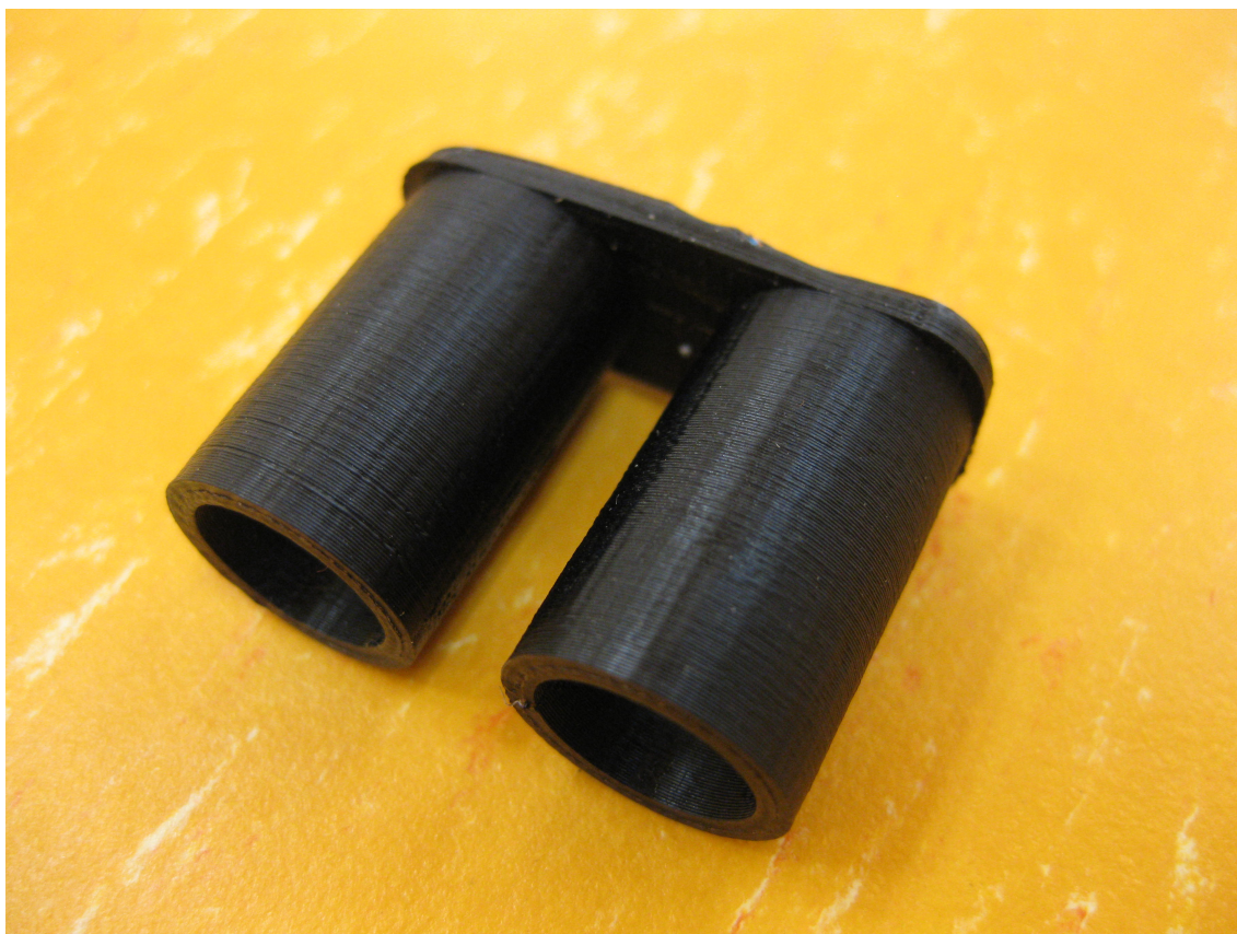
Obrázek 6.2: Nástavec na senzor SRF10 vytištěný 3D tiskárnou. Autorská fotografie.
