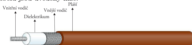
Obrázek 5.3. Popis použitého koaxiálního kabelu. Datasheet kabelu [27].
