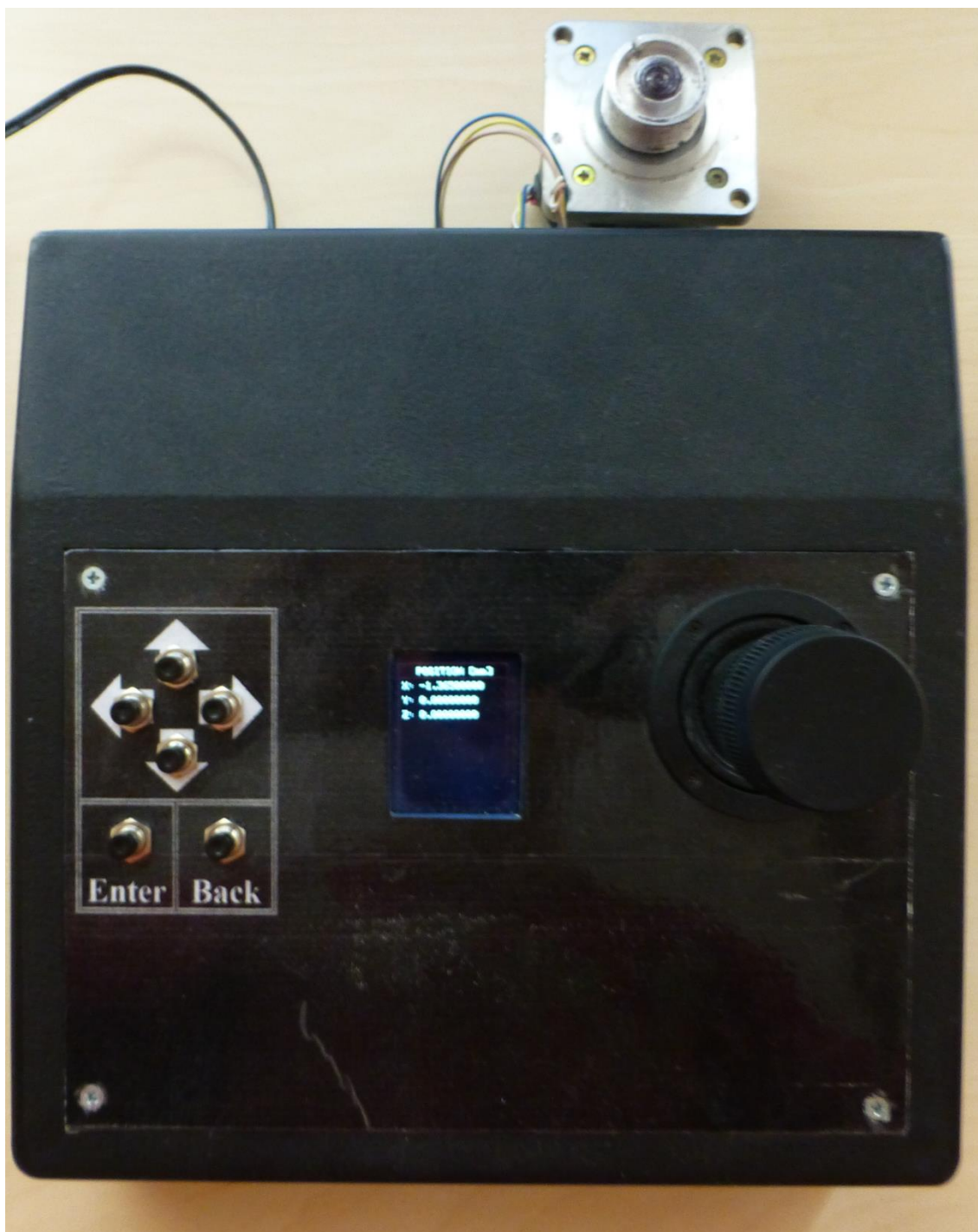
Obr. 24 Fotografie zapnuté řídicí jednotky s připojeným motorem
