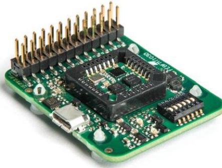
Obrázek 2.11: Evaluační deska Fairchild Semiconductor FEB-FMT1030_MEMS01, převzato z [13]
