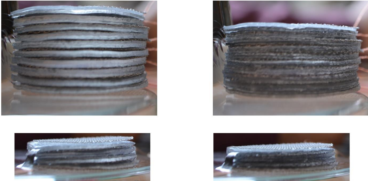
Obrázek 20: Aktuátor v klidu a při kontrakci, nahoře DOA gel, dole DIBA gel, vlevo v klidu, vpravo při kontrakci
