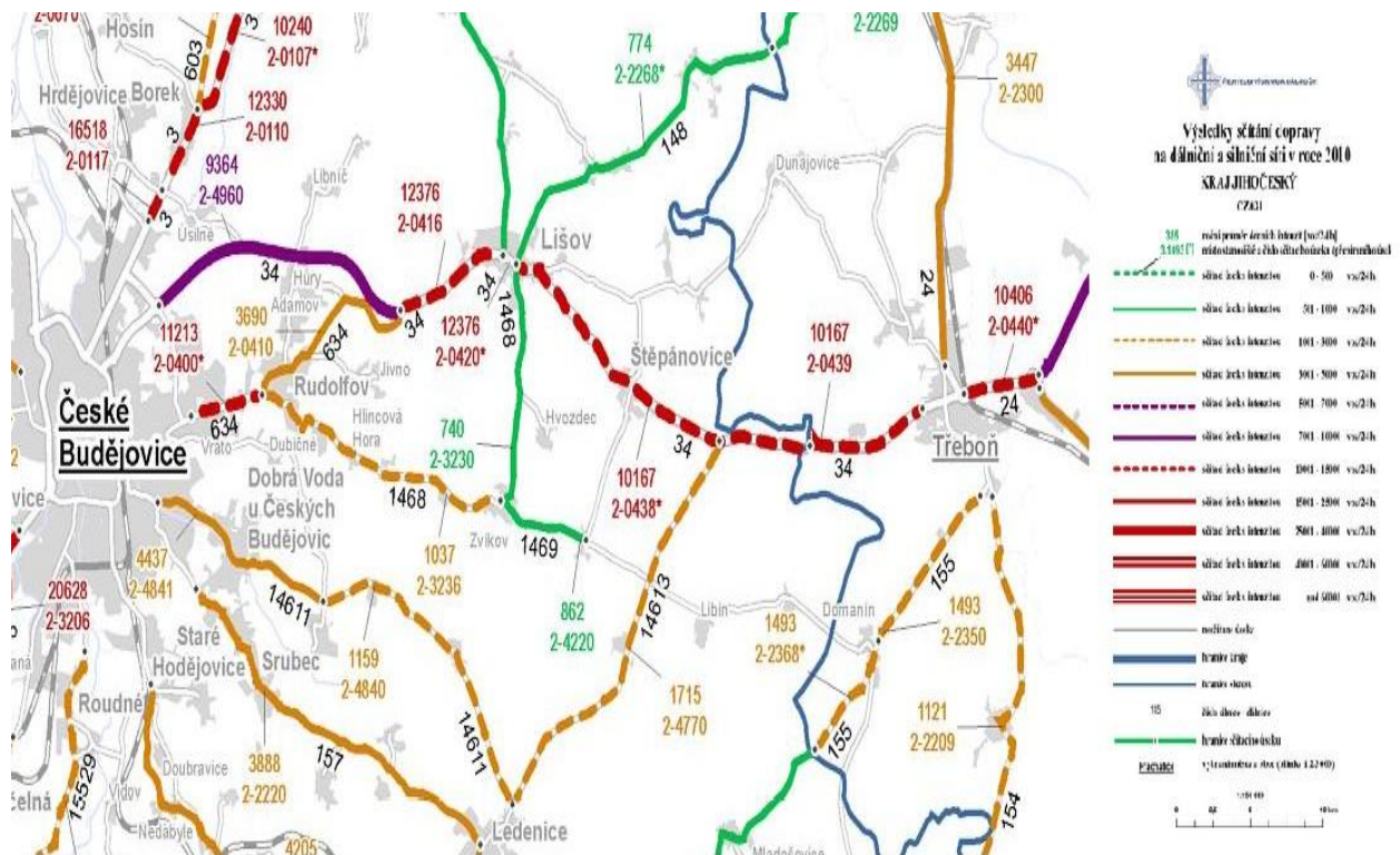
Obrázek č. 104. Výřez z mapy Výsledků sčítání dopravy na dálniční a silniční síti v roce 2010. [i5]
