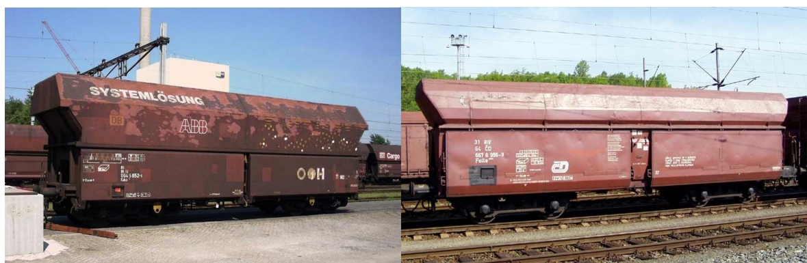
Obr. 3 – Srovnání vozů Falns 121 Railion-D a Falls typ 9-401.0 ČD (zdroj: www.parostroj.net )
