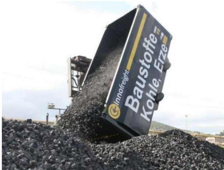
Obr. 9 – Vykládka kontejneru WoodTainer XL (zdroj: www.innofreight.com )
