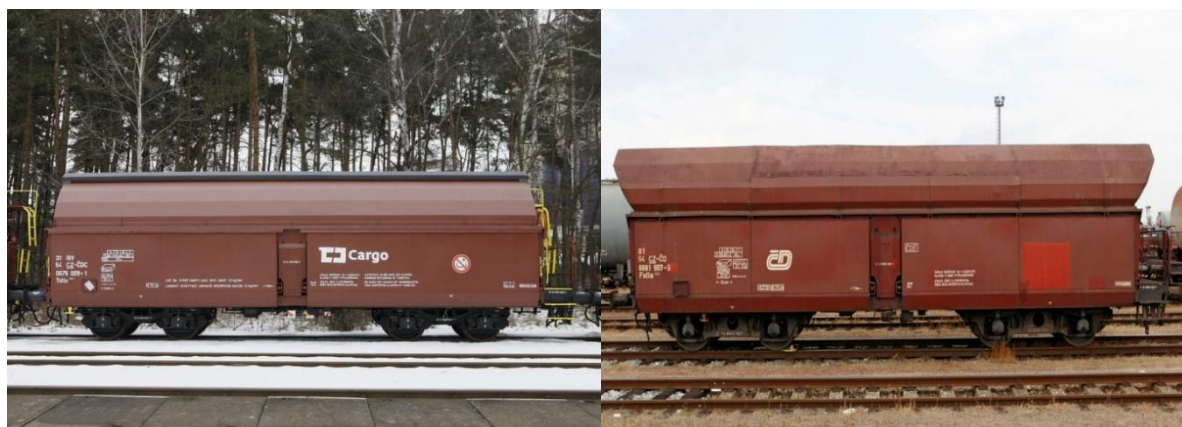
Obr. 6 – Srovnání vozů řady Talls a Falls (zdroj: www.cdcargo.cz )
