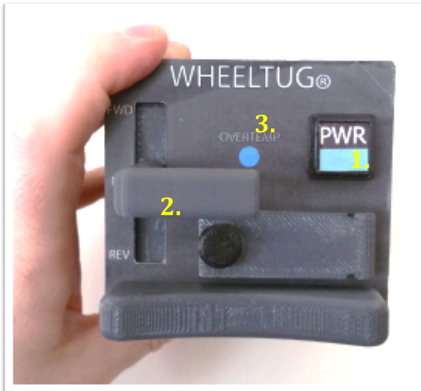
(07) Ovládací panel systému WheelTug [1]
