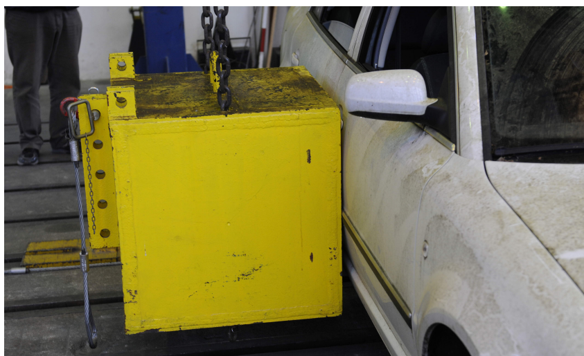
Obrázek 3.11: Nastavení dopadu zkušebního impaktoru, Zdroj: autor
