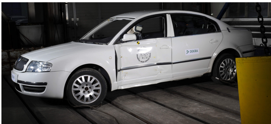
Obrázek 3.15: Škoda Superb po bočním nárazu, Zdroj: autor
