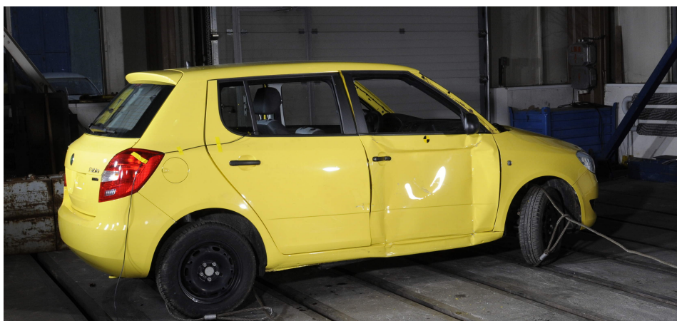
Obrázek 3.18: Druhý náraz do vozidla Škoda Fabia, Zdroj: autor
