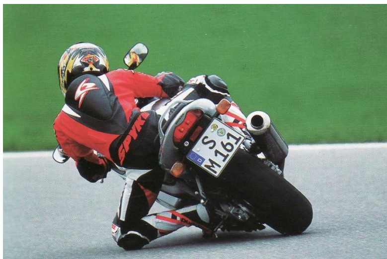
Obrázek 18: Náklon jezdce je větší než úhel klopení motocyklu [14]
