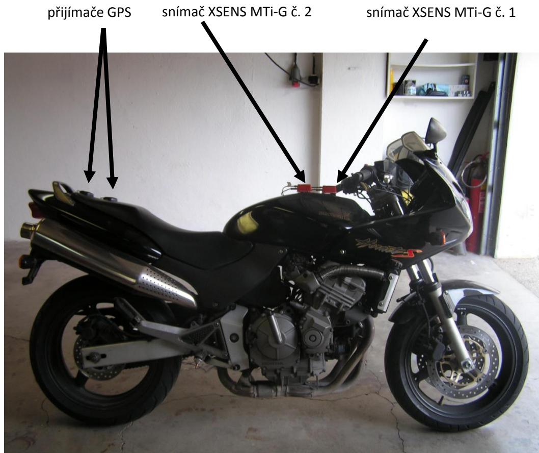
Obrázek 34: Umístění dvou snímačů XSENS MTi-G na motocyklu
