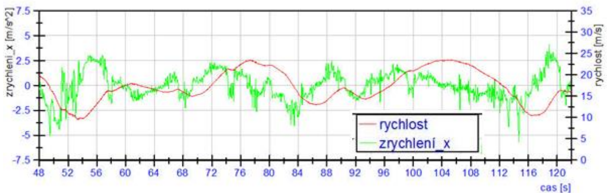
Obrázek 47: Průběh rychlosti při průjezdu úsekem pro měření úhlů klopení
