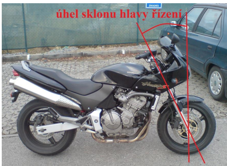
Obrázek 5: Způsob měření úhlu sklonu hlavy řízení u motocyklů
