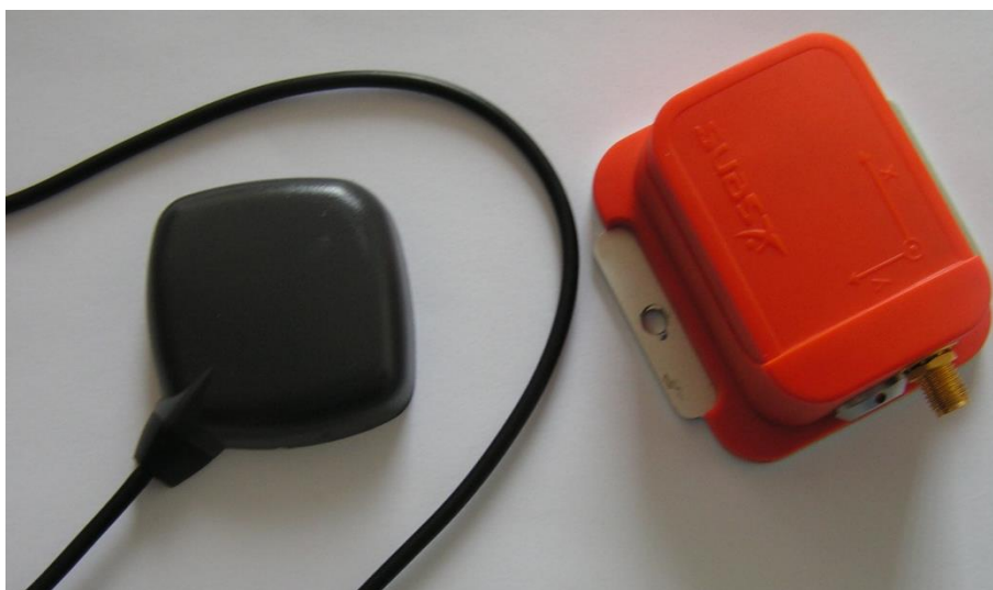
Obrázek 21: Snímač XSENS MTi-G a GPS přijímač [3]
