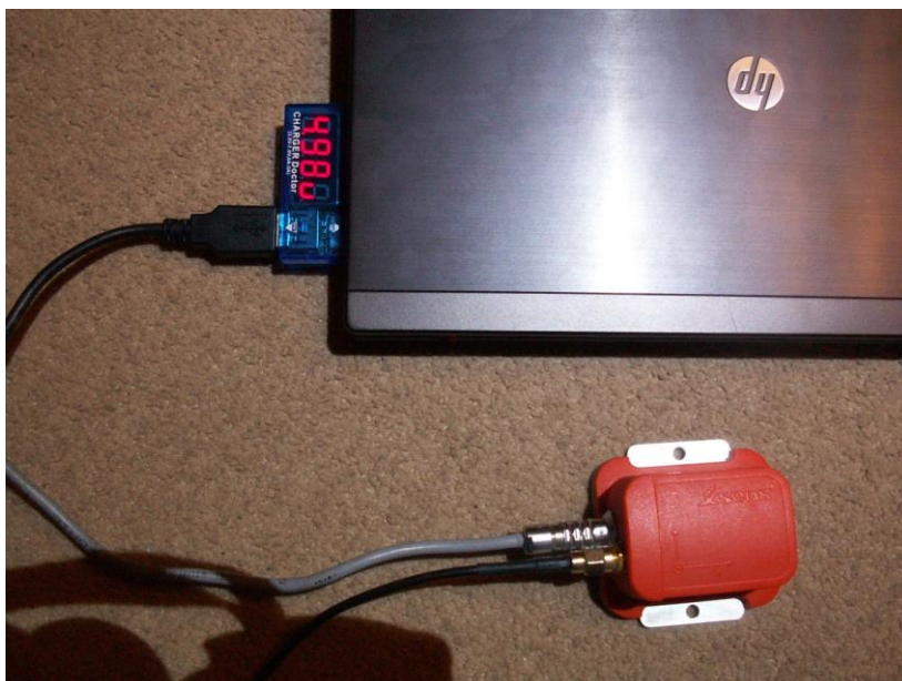
Obrázek 26: Napětí na portech při zavřeném notebooku
