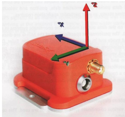
Obrázek 27: Souřadný systém snímače XSENS MTi-G [18]
