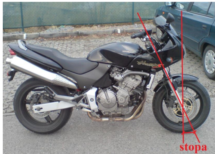
Obrázek 6: Závlek (stopa) předního kola motocyklu
