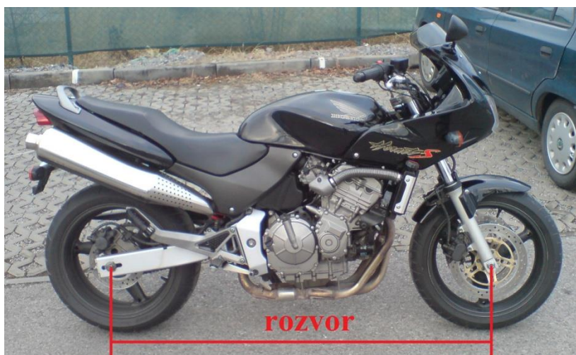
Obrázek 4: Znázornění rozvoru kol u motocyklu Honda CB600S Hornet
