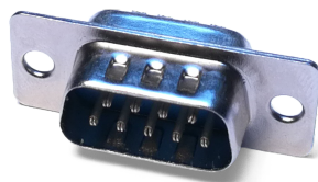
Obrázek 3.1: Konektor DE-9 typický pro sériové protokoly přenosu dat
