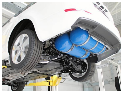
Obrázek č. 7: Škoda Octavia G-TEC, CNG nádrže (Zdroj: [28])
