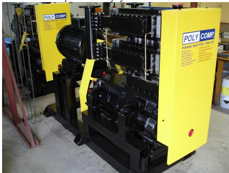
Obrázek 2.3. Pístový parní motor POLYCOMP PM-VS 1)
