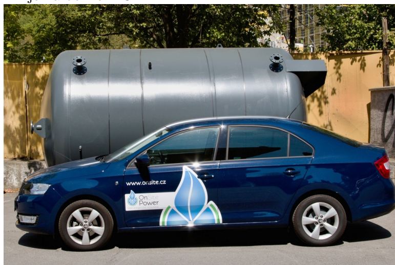
Obrázek 4.3. Porovnání velikosti akumulční nádrže o objemu 15 m 3 a osobního automobilu Škoda Rapid. Autor Vlastimil Černý
