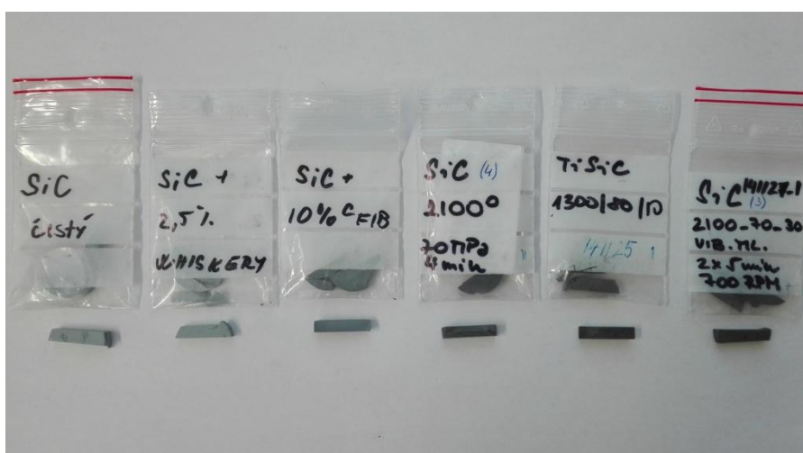
Obr. 3.34: Vzorky připravené pomocí metalografické pily MIKRON (MTH Hrazdil)
